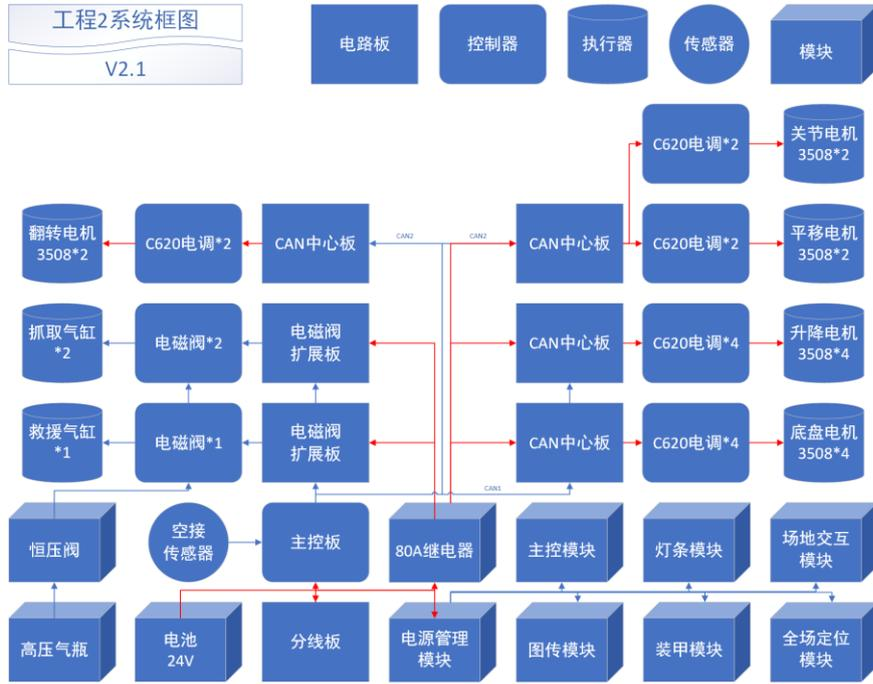
工程机器人系统框图
